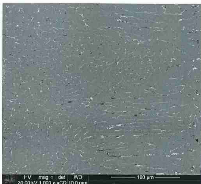
Figura 14: Imagem da amostra de strip-caster com aumento de 1000 vezes. Podemos ver a fase \Phi , cinza clara, a fase rica em Neodímio, nos contornos de grão. Não foi identificável a presença de \text{Fe-}\alpha . Fonte: autor
