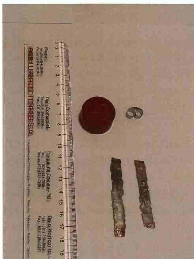
Figura 10: Tiras produzidas no primeiro ensaio do strip caster. Ao lado, uma das tiras embutidas em perfil lateral para análises e uma presilha de aço, usada para ajudar no embutimento. Fonte: autor
