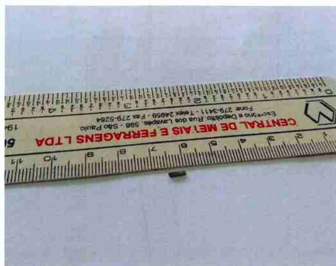
Figura 12: Um dos corpos de prova produzido a partir dos lingotes de liga base Nd-Fe-B
